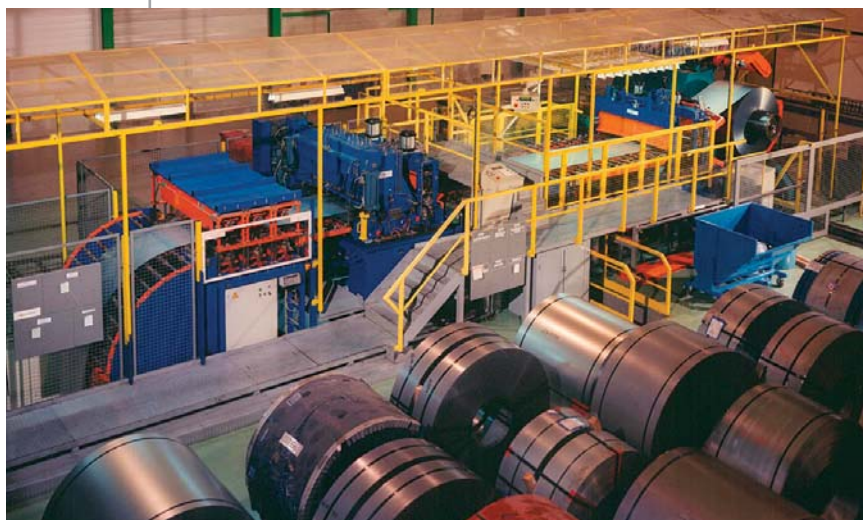
Ligne de déroulage pour bande largeur 2000 mm, épaisseur maxi 3 mm et bobines de 30 tonnes (installée chez un sidérurgiste).
