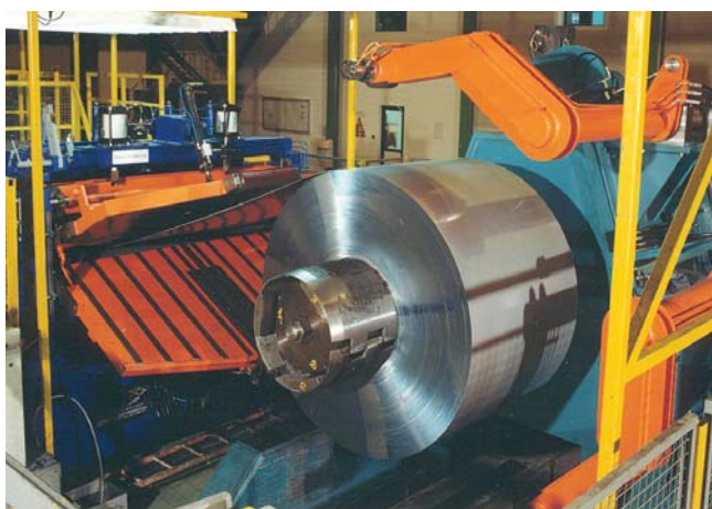
Dérouleur pour bobines de 30 tonnes en largeur 1850 mm et diamètre 2000 mm.
