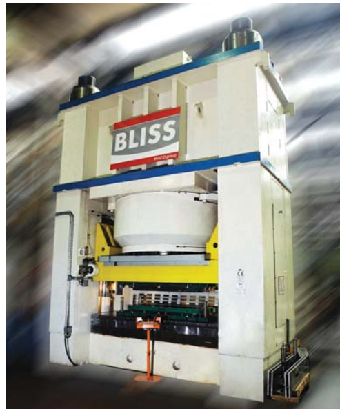
PHS 6000 La plus puissante que BLISS ait construite, 6000 tonnes sur un vérin de Ø 1600 mm pour réaliser le gaufrage de plaques en inox pour échangeur de température. Bâti particulièrement étudié pour garantir le formage homogène sur toute la surface de la pièce.
