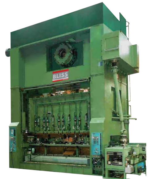
Presse 1 000 tonnes avec transfert mécanique trois axes, une table de 4000 x 1500 et deux plateaux bidirectionnels.
