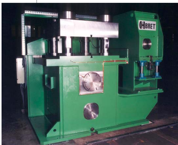
Presse à coulisseau tiré du modèle PAP25. PAP25 model underdrive press.
