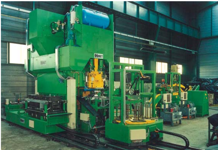
Presse transfert 400 tonnes avec ligne de découpe de flans, dépilleur de flans et changement rapide d'outil.
