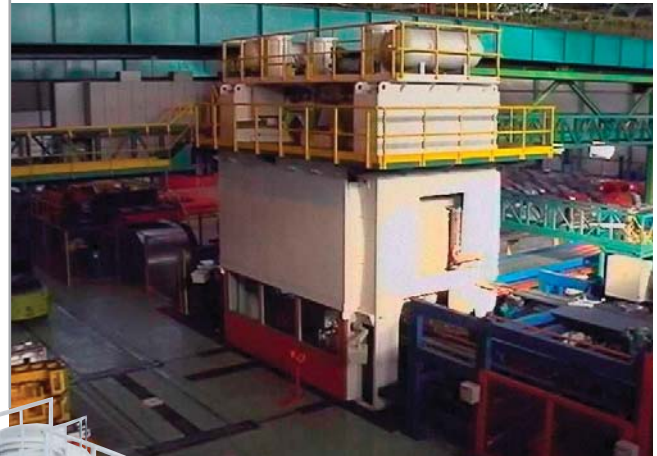
Presse quatre bielles 400 tonnes, table de 4 500 mm, intégrée dans une ligne de découpe.
