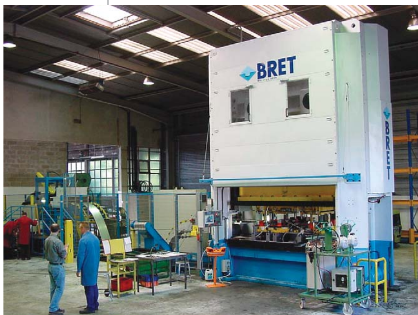
Presse arcade à deux bielles de 630 tonnes.
