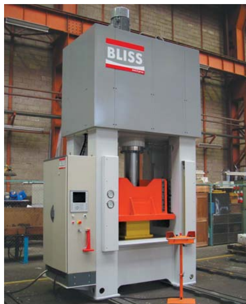
Presse type PHDm200, table spéciale de 1 250 x 1 000 mm. PHDm200 press, special 1 250 x 1 000 bolster.
